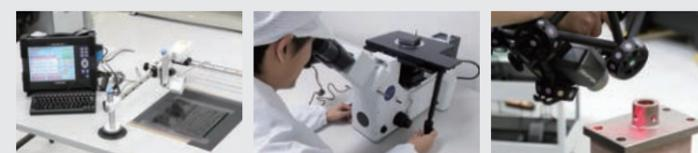
NDI検査装置    倒立光学顕微鏡    非接触測定器
