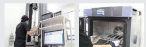
インストロン万能試験機    恒温恒湿槽
