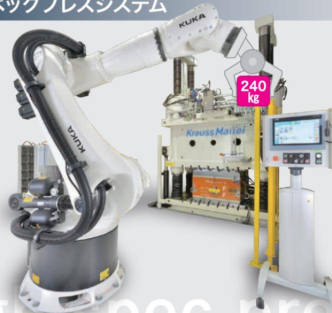
プレスシステムでは、熱硬化性樹脂 (CFRTS)、熱可塑性樹脂 (CFRTP)、HP-RTMを始め各種RTM成形が可能です。
