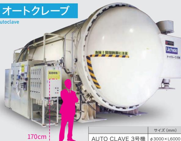
オートクレーブ (成形機) はプリプレグ (CFRP) を型に積層した製品を熱と圧力で樹脂を硬化させ形成する最も優れた成形方法です。
