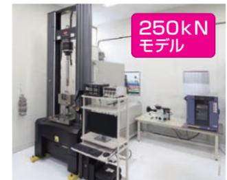
INSTRON製 5985型 長柱型・恒温槽付
