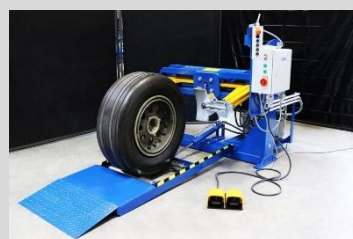
航空機ホイール ブレーキ整備設備
