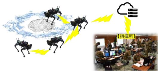
CR 警報ユニットは LCD 3.3 と空間線量だけでなく核種識別が可能な放射線検知器 (PM1704S) をネットワーク化させて、検知情報等をクラウドサーバに転送し、このクラウドサーバを通じて隊員側の携帯端末と管理側の PC に自動送信させることで、周辺住民への避難勧告や立ち入り禁止区画の設定など、早期対応を実現させることが可能なシステムです。
