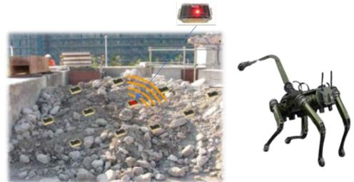
独自技術(人の呼吸や心拍による微小な動きまでも検出可能なセンサー)により、人命救助用に開発された電磁波探査装置です。多数分散配置探査方式、要救助者の存在が予測されるエリアの瓦礫や倒壊物の上に分散配置し、一帯を無人で常時探査します。
